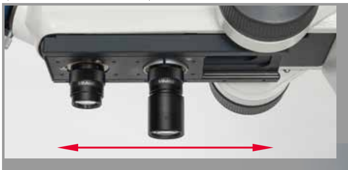
滑动式物镜交换座上安装两个物镜的示例
