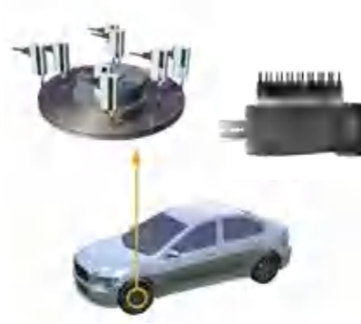
② 刹车盘的多点测量
