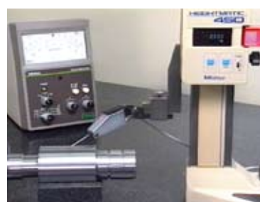
3点法使用千分表和V型块，具有较好的分辨率，但对一般的凸角状况不敏感。
