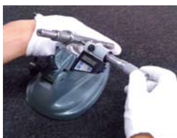
使用千分尺进行直径测量不能检测圆柱凸角为奇数的情况且分辨率很低。
