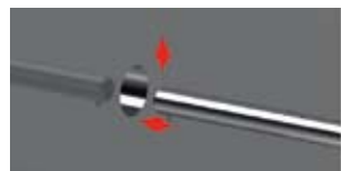
微動つまみ(手動)を使った小穴測定の位置決めイメージ
